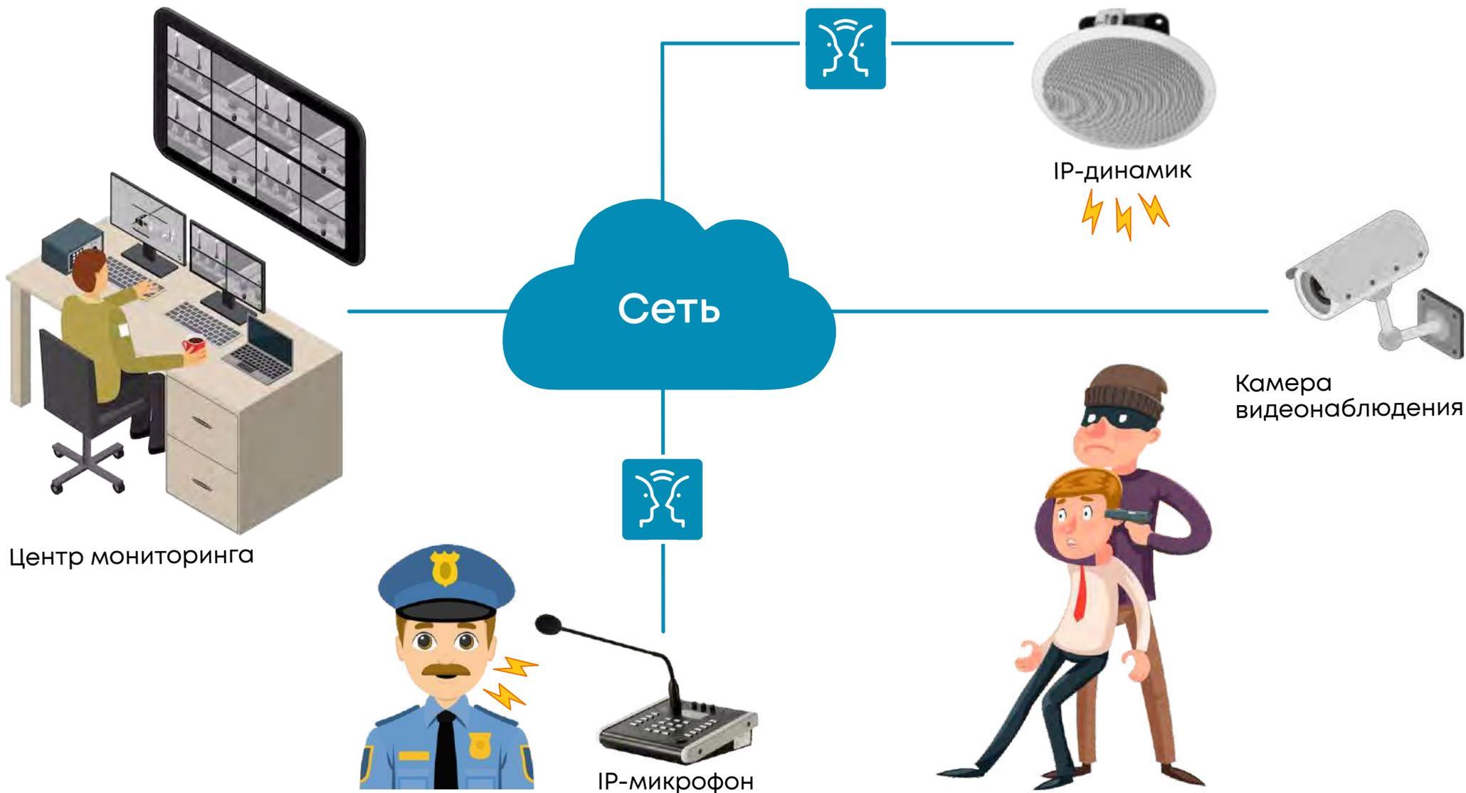
Двухсторонняя связь между IP громкоговорителями и микрофонной панелью обеспечивает возможность координации действий в условиях чрезвычайной ситуации.
