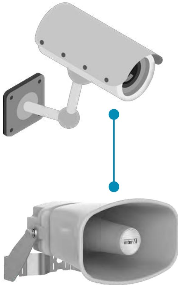
Автоматическое оповещение по «сухому» контакту с камер видеонаблюдения
