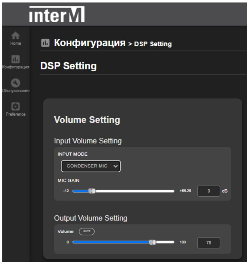
В подменю "Input Volume Setting" осуществляется отключение ("Disabled") или включение ("Condenser MIC") встроенного в IP-громкоговоритель контрольного конденсаторного микрофона. Динамики IP-1015WS, IP-1015CS, IP-1015HS по умолчанию настроены на "Condenser MIC", в состоянии "Disabled" микрофон для аудиомониторинга текущего IP-динамика не используется.
