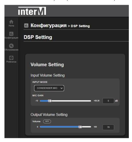
В подменю "Input Volume Setting" осуществляется отключение ("Disabled") или включение ("Condenser MIC") встроенного в IP-громкоговоритель контрольного конденсаторного микрофона.
