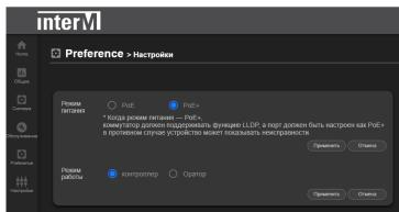
При выборе PoE+ отображается предупреждение о том, что порт коммутатора должен быть настроен как "PoE+", а сам коммутатор должен поддерживать функцию LLDP (протокол обнаружения канального уровня).
