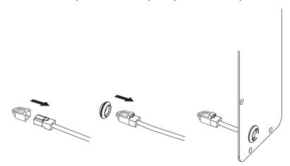
Вставив (при необходимости) SD-карту в слот модуля IP-1015BX, подключить отклемпованный патч-корд к разъему RJ-45:
